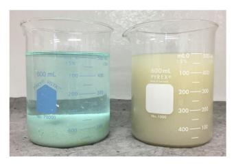
Пробирка слева показывает реактивную глину в воде с добавлением ClayLock. Пробирка справа показывает реактивную глину в воде без добавок.
